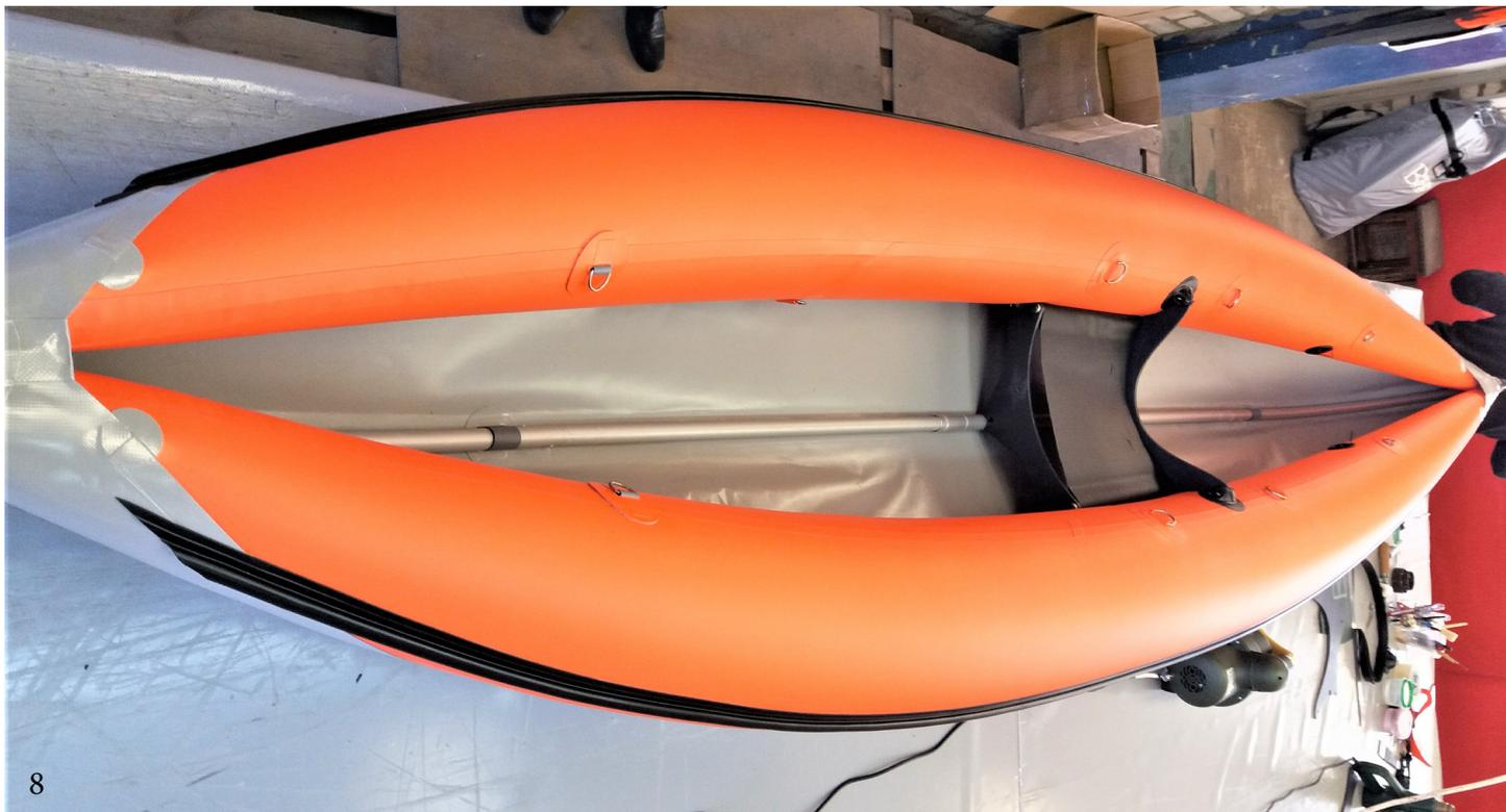
9. Установка сидения со спинкой. С нижней стороны сидения расположены две ленты с липучкой «велькро». Ленты продеваются через прорези в основании сидения и фиксируются с внутренней стороны при помощи липучек. Лента сидения продевается в переднее полукольцо и фиксируется в 3-х щелевой пластмассовой пряжке, при помощи которой можно регулировать наклон спинки. Через петли спинки при помощи шнура крепится к задним полукольцам, что позволяет удерживать спинку от падения вперед.
