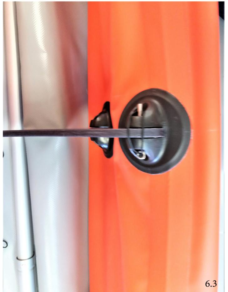
7. В основу сидения из ПВХ-ткани вдеть опорные трубки  $\Phi 18$  мм. Концы трубок вставить в отверстия большого шпангоута. С другой стороны на эти трубки одеть низкий шпангоут и также закрепить его к бортам через фиксирующие шайбы при помощи нержавеющей штырей  $\Phi 6$  мм.
