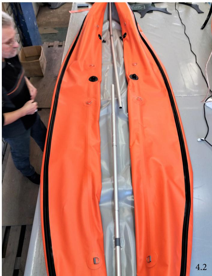
5. Приподняв концы труб носовой и кормовой частей кильсона соединить их, вставив шип одной трубы в отверстие другой. Плавно опускайте трубы кильсона вниз и следите чтобы шип не выскочил из отверстия а носовые и кормовые штевни ровно легли по середине дна. После того как кильсон ляжет на дно, закройте его соединительной трубкой и зафиксируйте пружинным фиксатором в отверстие трубки.
