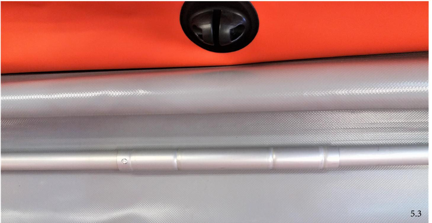
6. Взять большой шпангоут. Закрепить большой шпангоут к внутренним бортам корпуса лодки. Шпангоуты крепятся в специальные фиксирующие шайбы из ПВХ при помощи нержавеющей штырей  $\Phi 6$  мм.
