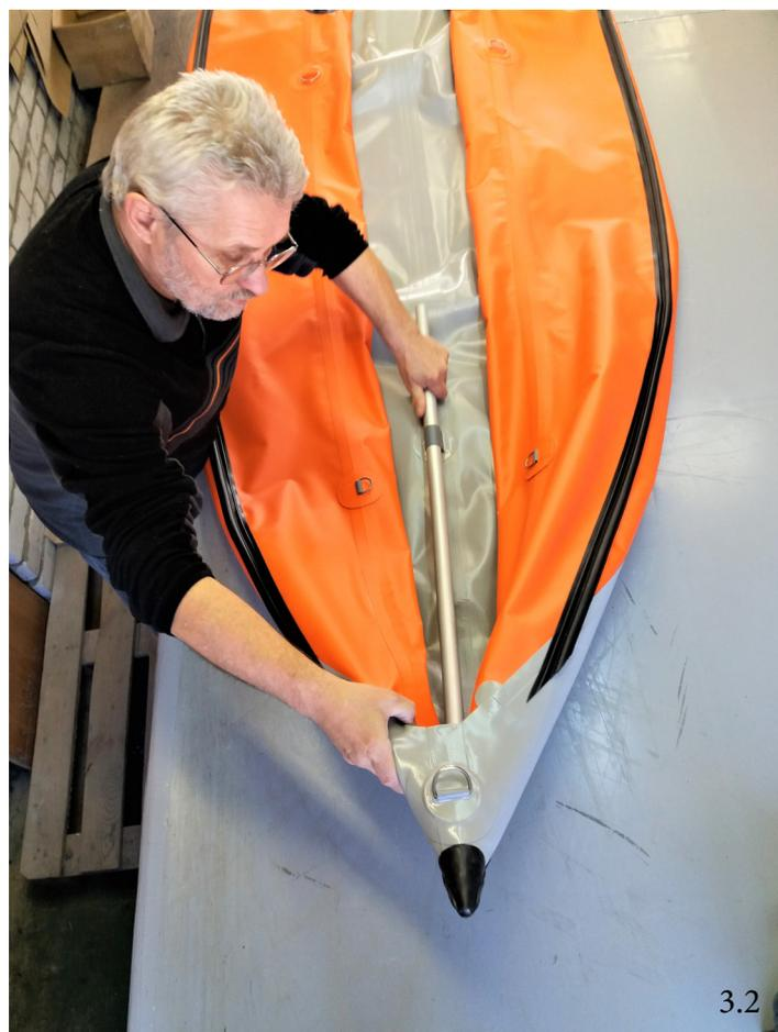
4. Взять средние трубы кильсона и соединить со штевнями. Расположение корма – нос не имеет значения. Фиксатор на одной из частей расположить сверху. На другой части должен быть надета соединительная труба.
